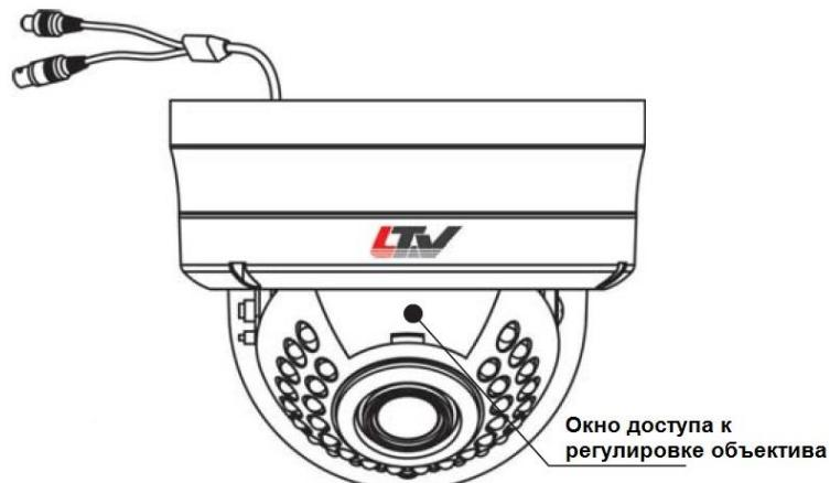
Рис.3.3.1. Схематичное изображение LTV-CDH-720L-V2.8-12
